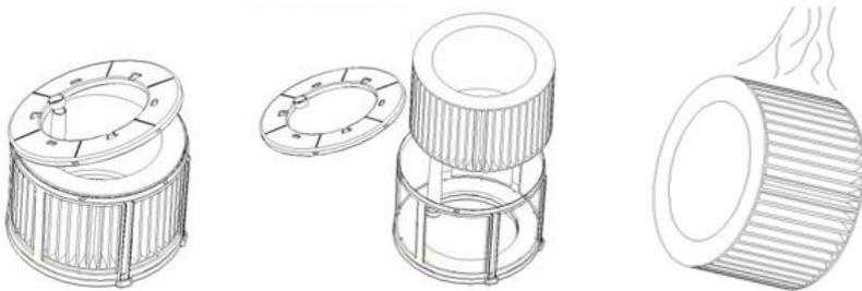
4.1 Retirez le couvercle situé au bas du composant du filtre et détachez le filtre évaporatif de son support.
